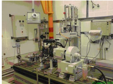
شکل ۳- دینامومتر و سکوی آزمون موتور (آزمایشگاه موتور مگاموتور) و دستگاه تحلیل‌گر گازهای خروجی از موتور
